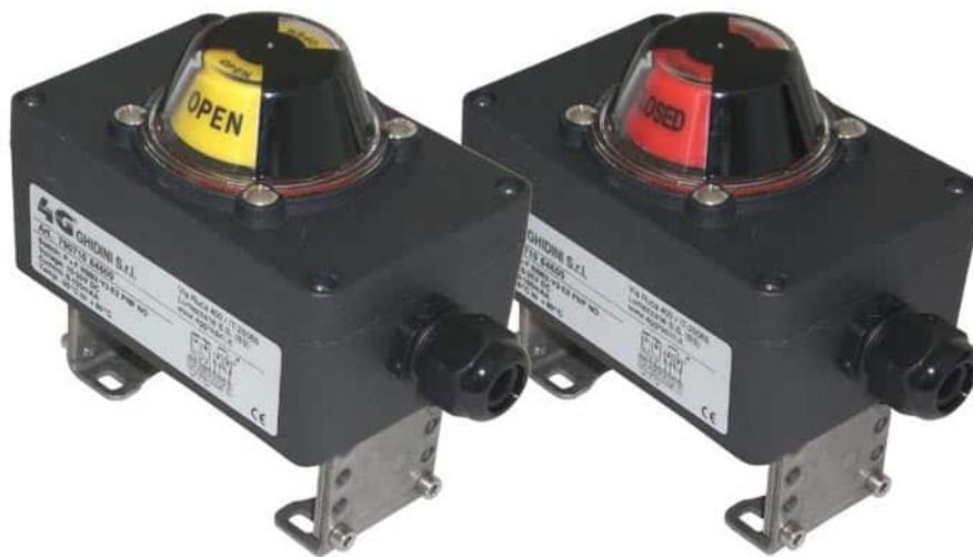
Box in alluminio verniciati con polvere epossidica nera, forniti completi di staffa universale regolabile per applicazione su tutta la nostra gamma di attuatori (L=30×80/130-H=20/30).
